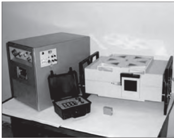
شکل ۲: یک نمونه بتاترون ۷,۵ مگا الکترون ولتی مورد استفاده در رادیوگرافی [۴]
