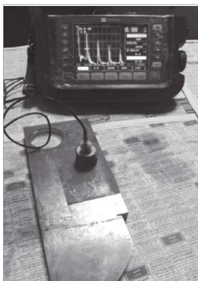
شکل (۴) نمونه ای از تست کوپلنت جامد برای رسیدن به ارتفاع پالس ۸۱ درصد صفحه نمایش با تقویت آمپلی فایر
