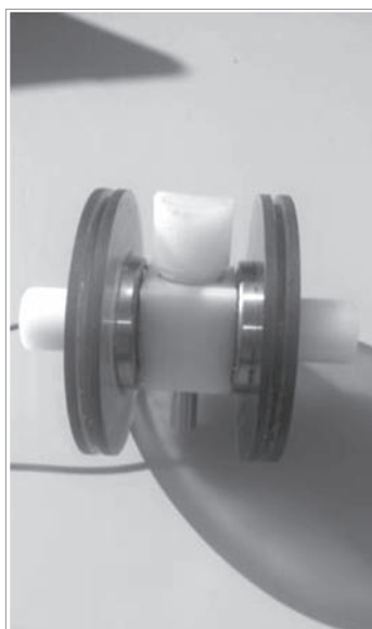
شکل (۲) نمای داخلی ویل پراب کوپلنت های جامد
