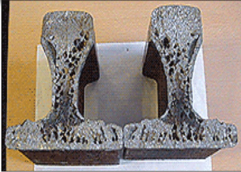
شکل ۳ - نمونه ای از تخلخل
