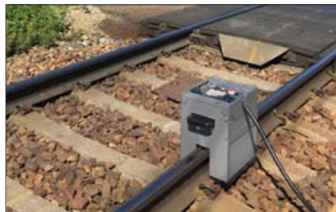
شکل ۷ - دستگاه بازرسی با موج هدایت شده
