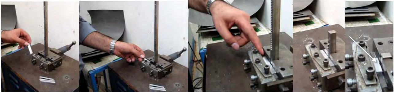
شکل-۵۰۲: مراحل ایجاد شیار با عمق ۲ میلیمتر و زاویه ایی برابر با ۴۵ درجه
