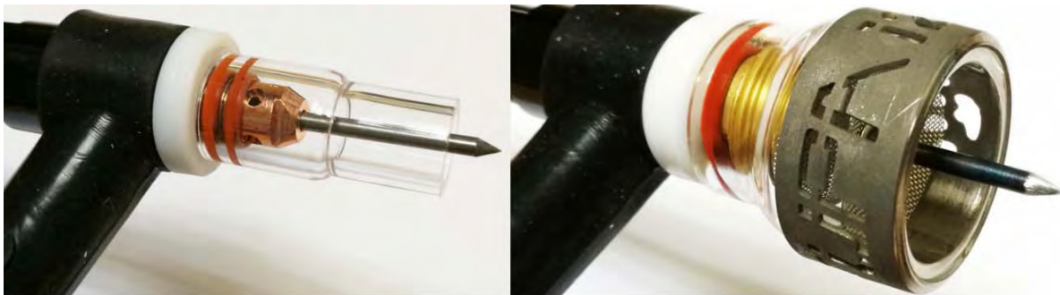
شکل-۳۲۱: اشکال مختلف نازل های تورچ جوشکاری در فرآیند GTAW
