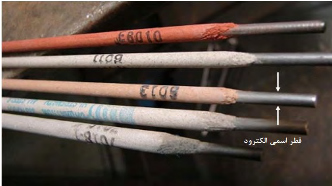
شکل-۱۲۶: قطر اسمی الکتروود
