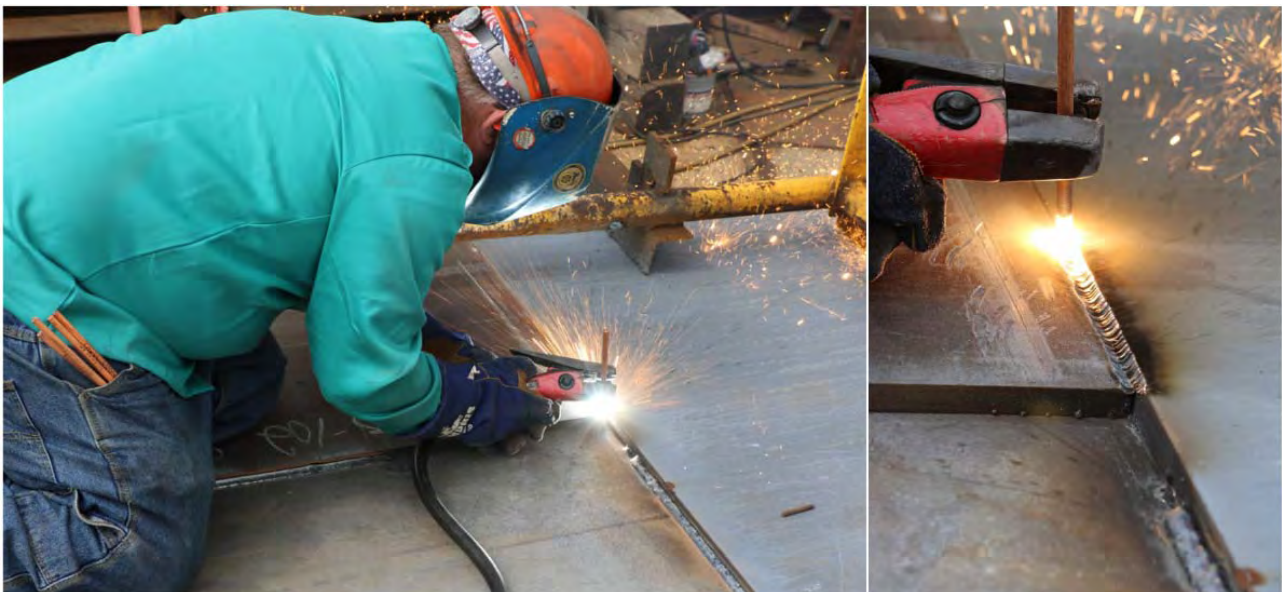
شکل-۲۵۰ : طریقه اجرای روش BACK GOUGING
