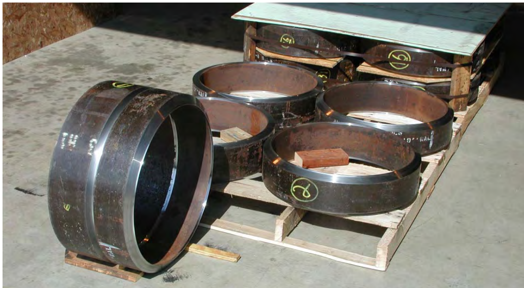
شکل-۳۹۷: قطعات PQR تهیه شده از لوله
