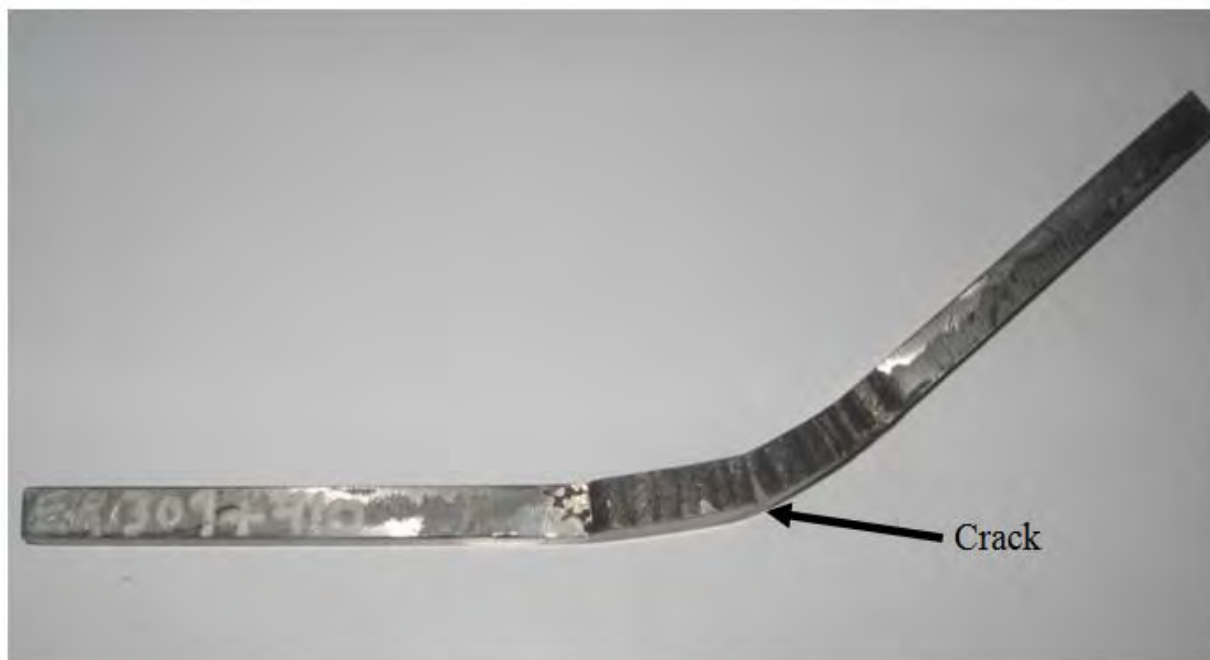
شکل-۴۴۲: نمونه تست خمش از جوش مقاوم به خوردگی corrosion-resistant weld overlay cladding
