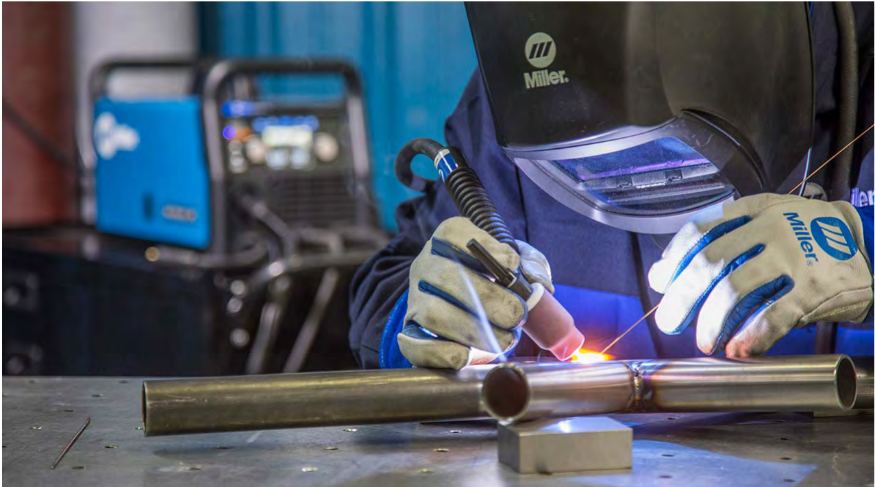
شکل-۳۱۹: نمونه ای از تورچ جوشکاری در فرآیند GTAW
