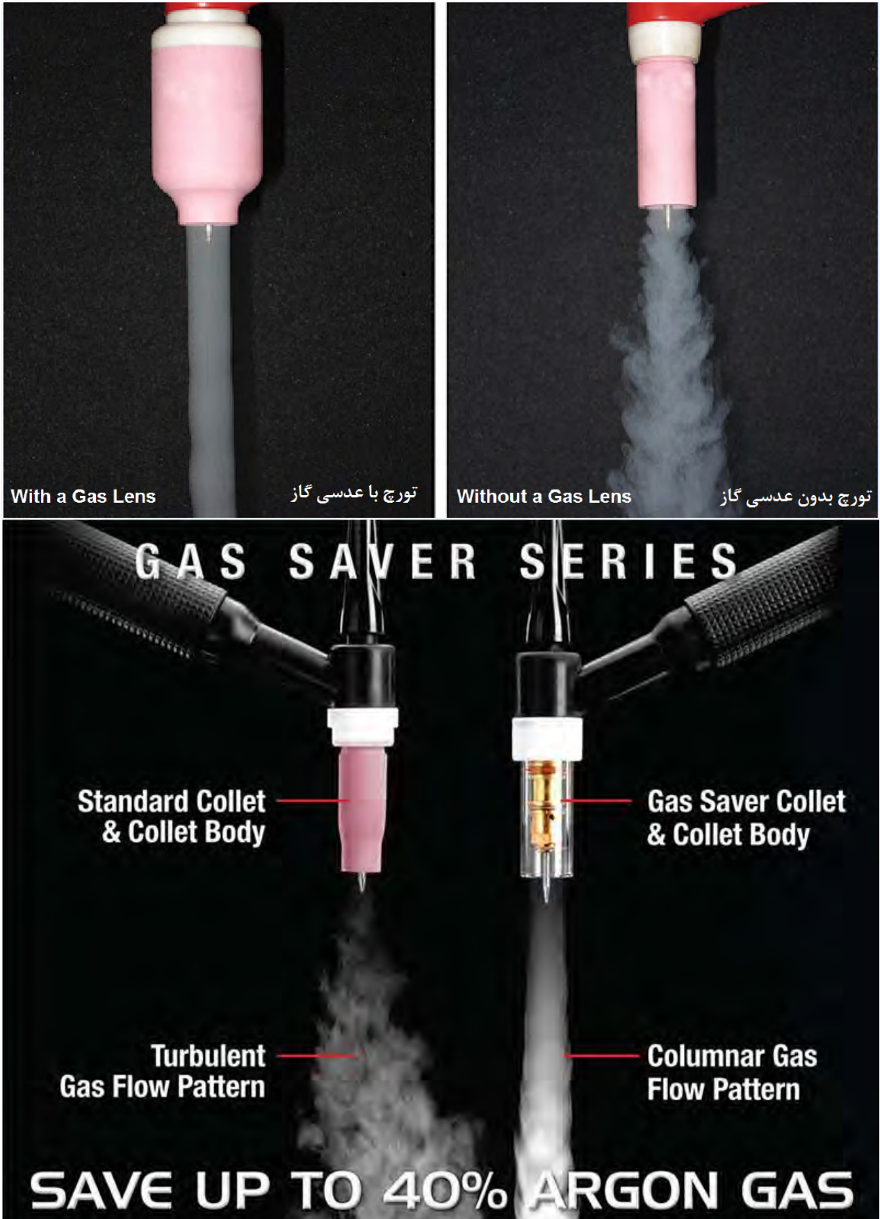
شکل-۳۲۵: تورچ با عدسی گازی و بدون عدسی گازی در جوشکاری فرآیند GTAW
