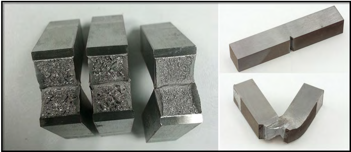
شکل-۵۰۸: نمونه هایی از قطعات تست ضربه قبل و بعد از شکسته شدن بر اثر ضربه
