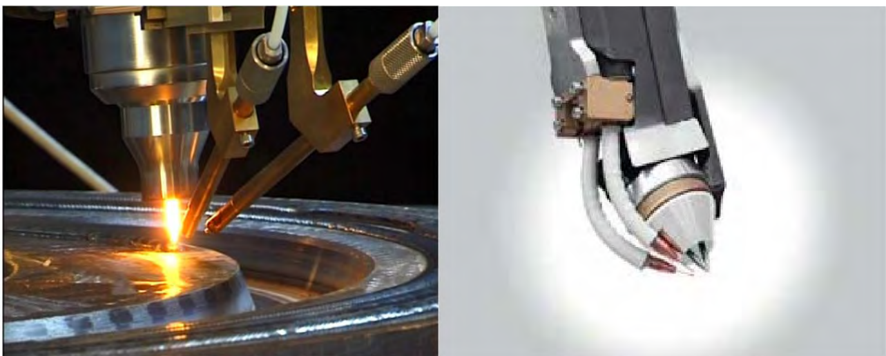
شکل-۳۳۶: استفاده چند فیلمتال در فرآیند جوشکاری اتوماتیک GTAW
