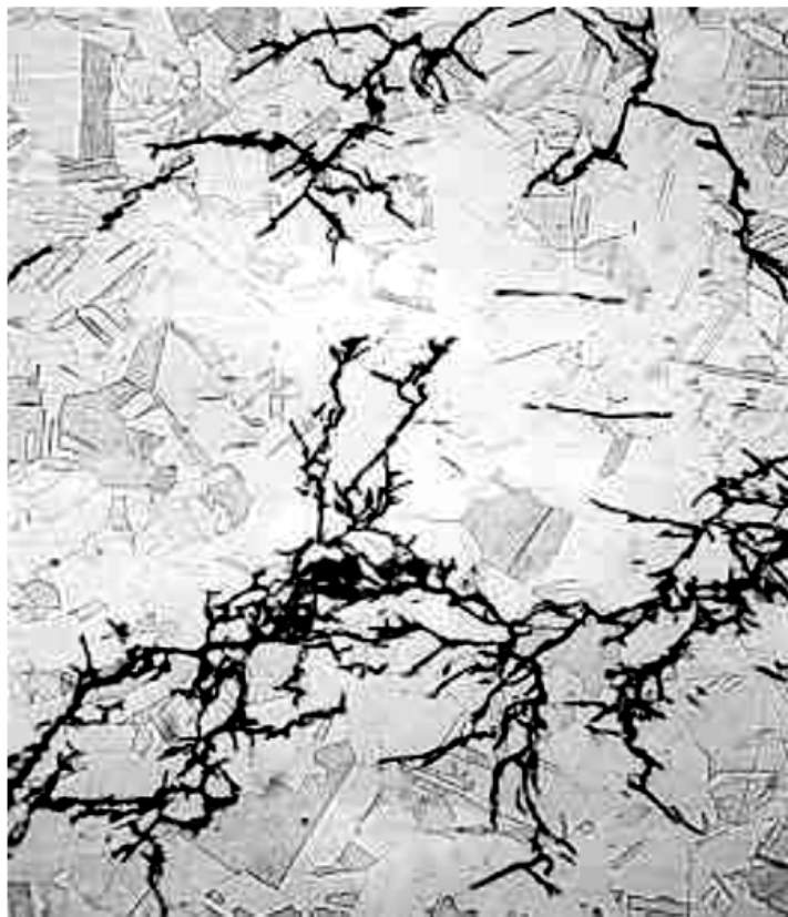
تصویر ۲: ترک میان دانه ای (Transgranular)
