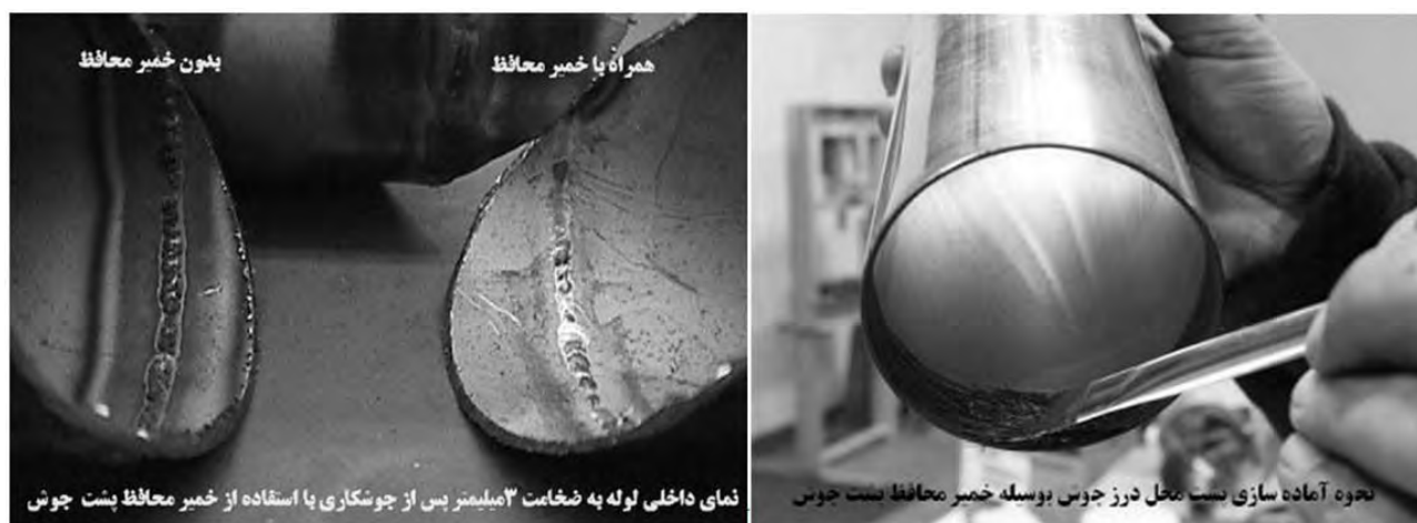
شکل-۲۷۱: مقایسه قطعات در شرایط استفاده از خمیر محافظ و عدم استفاده از این خمیر.
