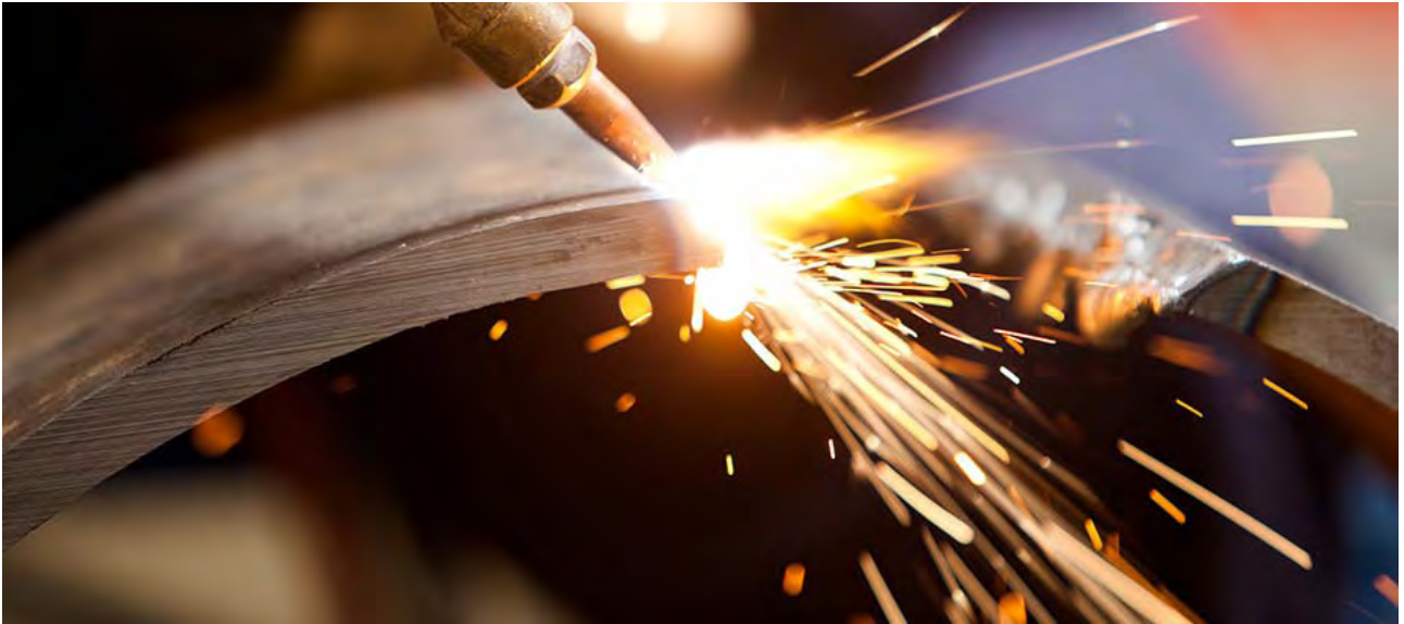
شکل-۲۴۴: مکانیزم برشکاری شعله ای اکسی گاز
