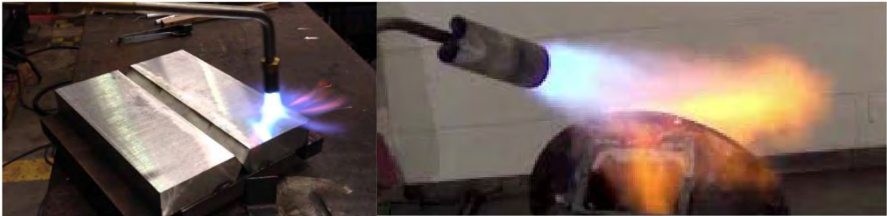
شکل-۱۷۹: پیشگرمی با استفاده از مشعل پروپان
