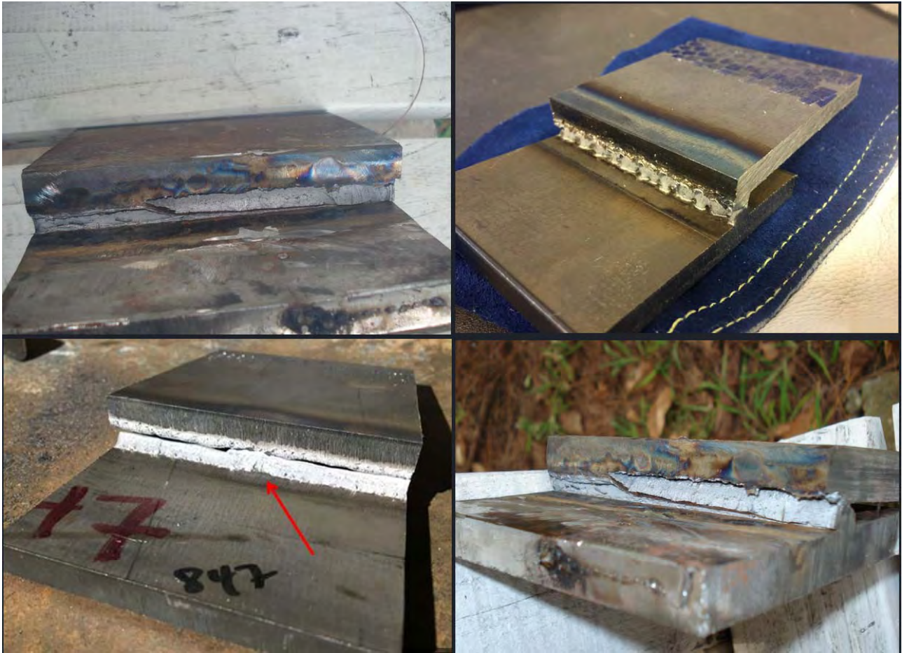
شکل-۶۹۱: نمایی از سطح مقطع جوش Fillet پس از تست شکست
