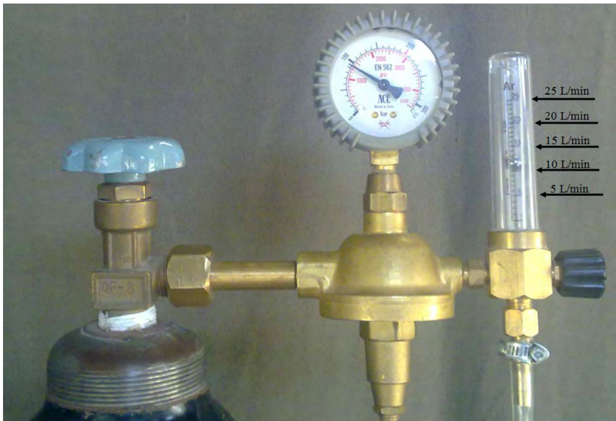
شکل-۲۹۸: تنظیم کننده (Regulator) نرخ جریان (Flow rate) گاز محافظ
