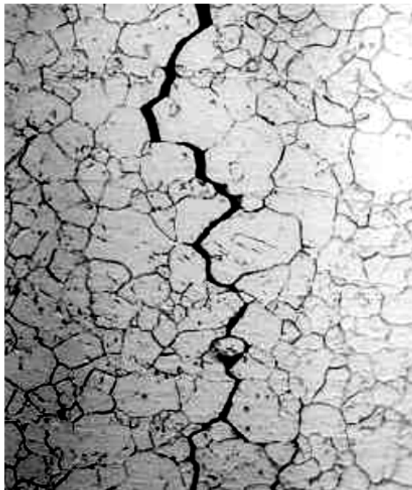
تصویر ۱: ترک بین دانه ای (Intergranular)
