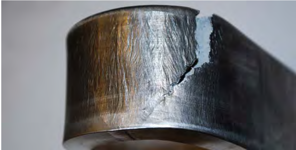
شکل-۴۳۹: نمونه ایی از مردود شدن قطعه تست در آزمایش خمش
