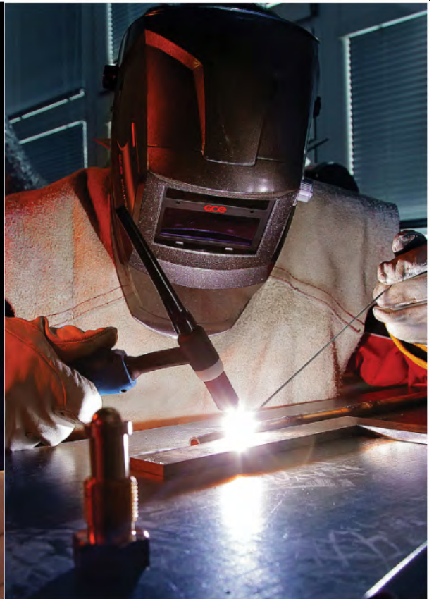
شکل-۲۵۱: فرآیند جوش آرگون GTAW
