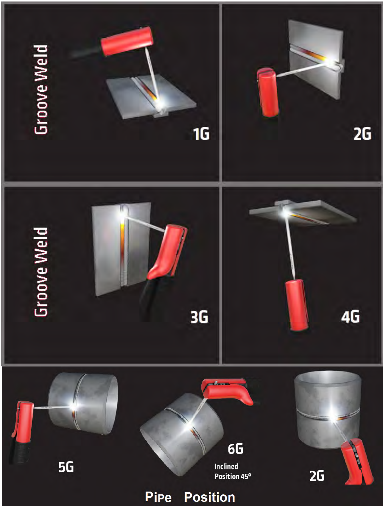
شکل-۶۲۳: وضعیت‌های جوشکاری ورق و لوله در جوشهای Groove مطابق استاندارد ASME Sec IX-2019
