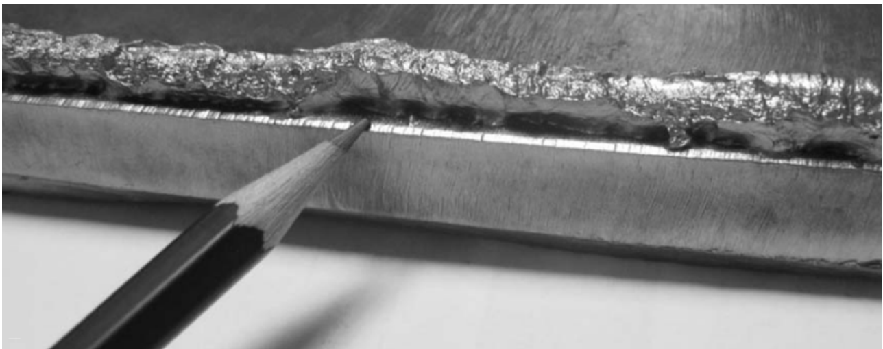
شکل-۶۹۲: تست کوپن جوش گوشه ایی تست جوشکاری پس از شکست
