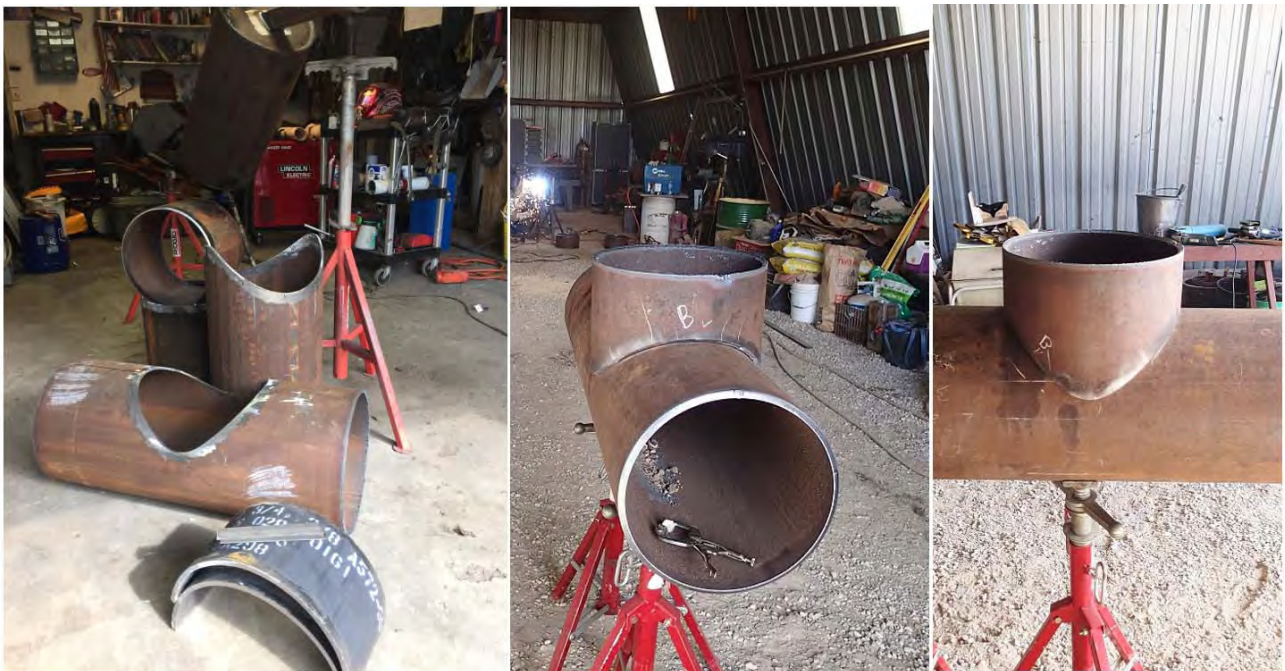
شکل-۵۹۸: آماده سازی قطعه تست برای تست جوشکار به روش Multiple Qualification
