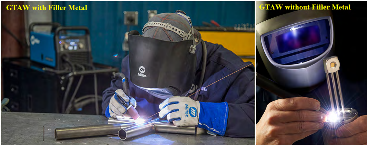
شکل-۲۶۰: جوشکاری با فرآیند GTAW در حالت با فیلر و بدون فیلر متال
