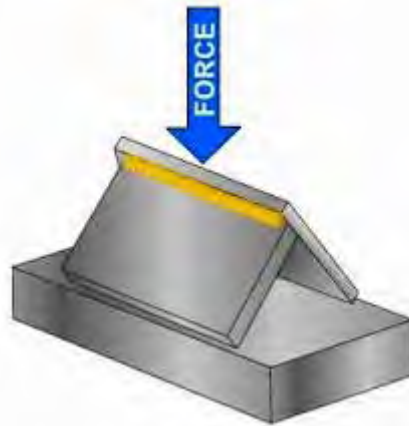
شکل-۶۸۶: روش شکستن تست کوپن تست جوش Fillet جوشکار
