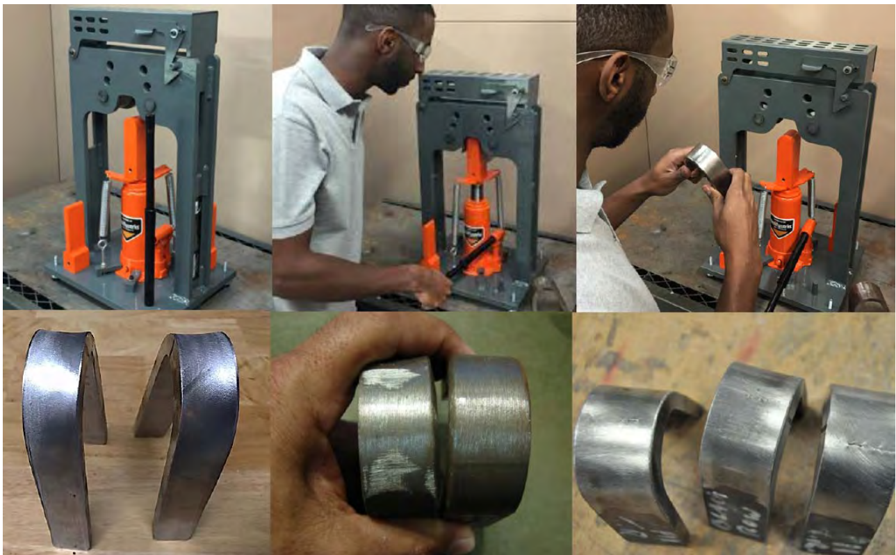
شکل-۶۸۴: نحوی تست خمش برای قطعات تست کوپن جوشکار در کارگاه با استفاده از جک هیدرولیک
