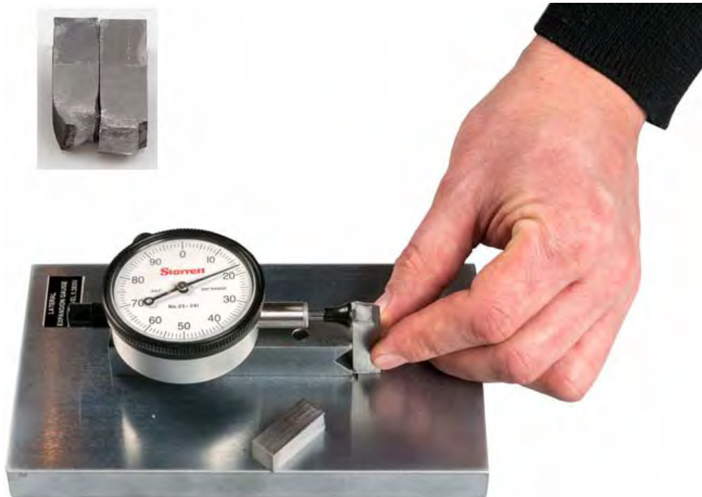
شکل ۵۶۶: طریقه بدست آوردن میزان Lateral expansion با استفاده از Lateral Expansion Gauge
