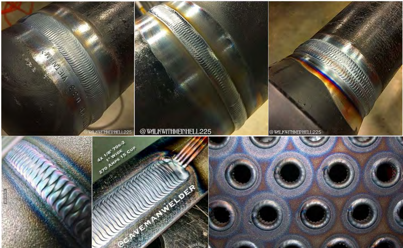
شکل-۲۵۲: نماهای مختلفی از جوش GTAW
