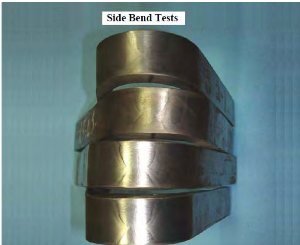
شکل-۴۳۸: نمونه تستهای خمش از پهلوئی جوش در حالت Transverse
