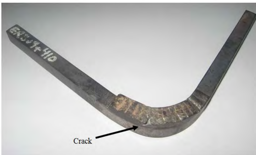
شکل-۴۴۰: نمونه تست خمش از جوش مقاوم به خوردگی corrosion-resistant weld overlay cladding
