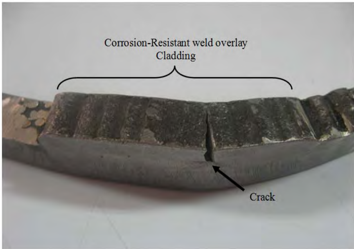
شکل-۴۴۳: نمونه تست خمش از جوش مقاوم به خوردگی corrosion-resistant weld overlay cladding
