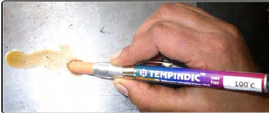
شکل-۱۸۲: گچ حرارتی Tempil Stick
