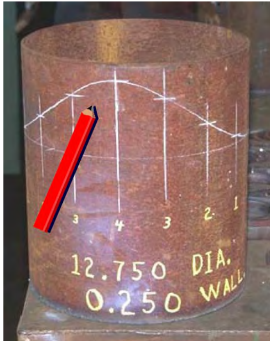
شکل-۵۹۷: آماده سازی قطعه تست برای تست جوشکار به روش Multiple Qualification
