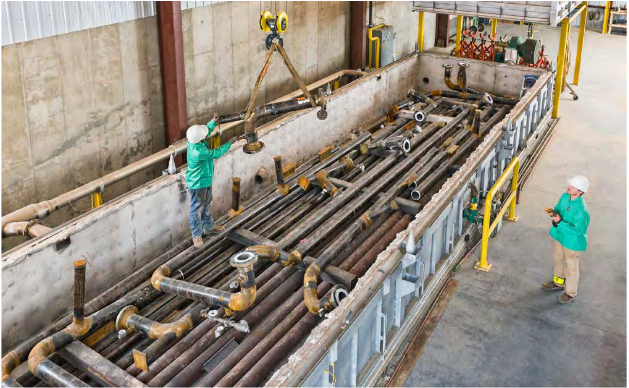
شکل-۲۰۱: تنش زدایی بصورت Spool های جمعی در کوره تنش زدایی در سیستم لوله کشی صنعتی
