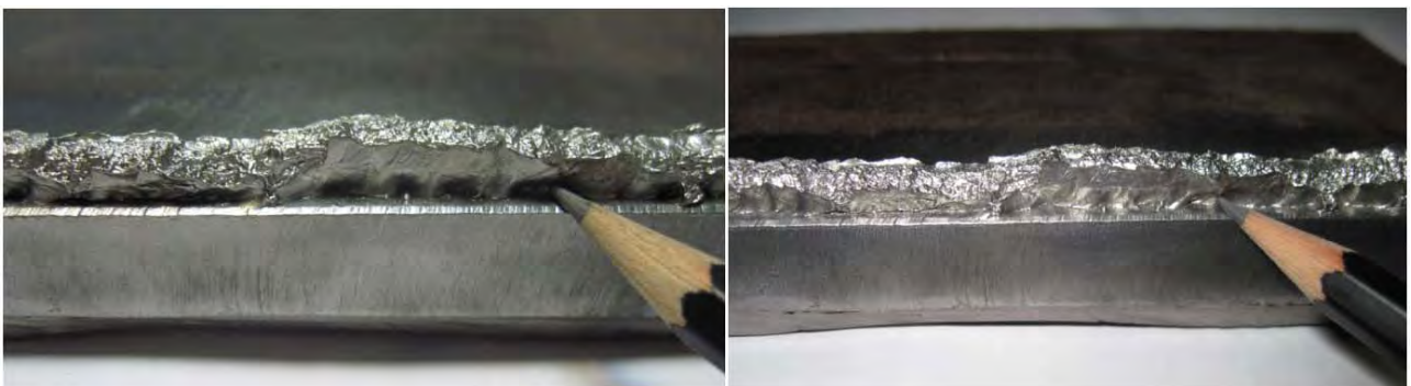
شکل-۶۹۰: تست جوشکاری که پس از تست شکست مردود اعلام گردید.
