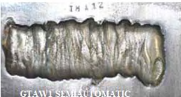
شکل-۲۸۴: نمایشی از جوشهای رسوب داده شده پودری با فرآیند GTAW اتوماتیک و نیمه اتوماتیک
