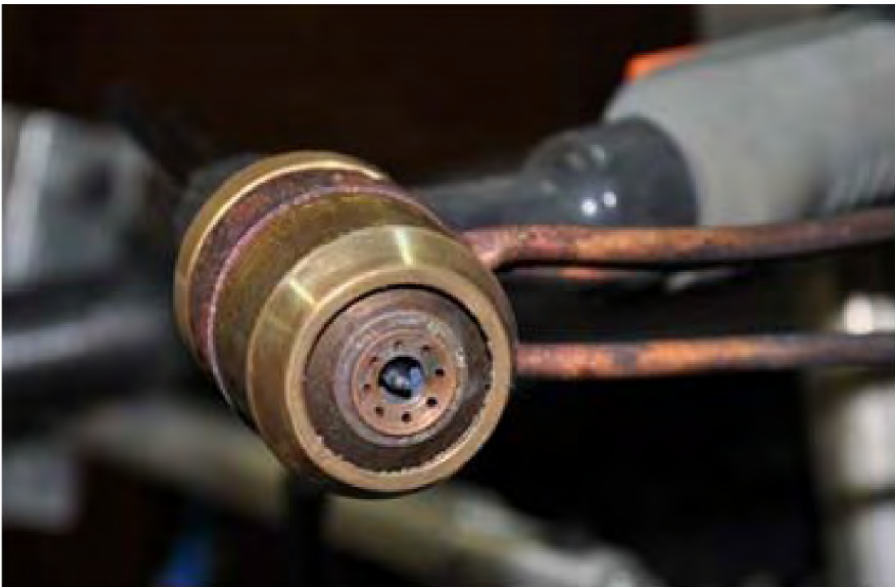
شکل-۲۸۲: عکس نمای پایین تورچ سیستم GTAW که با استفاده از هشت سوراخ پودر را تزریق می کند.
