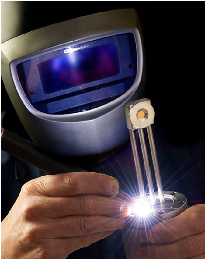
شکل-۲۵۱: فرآیند جوش آرگون GTAW
