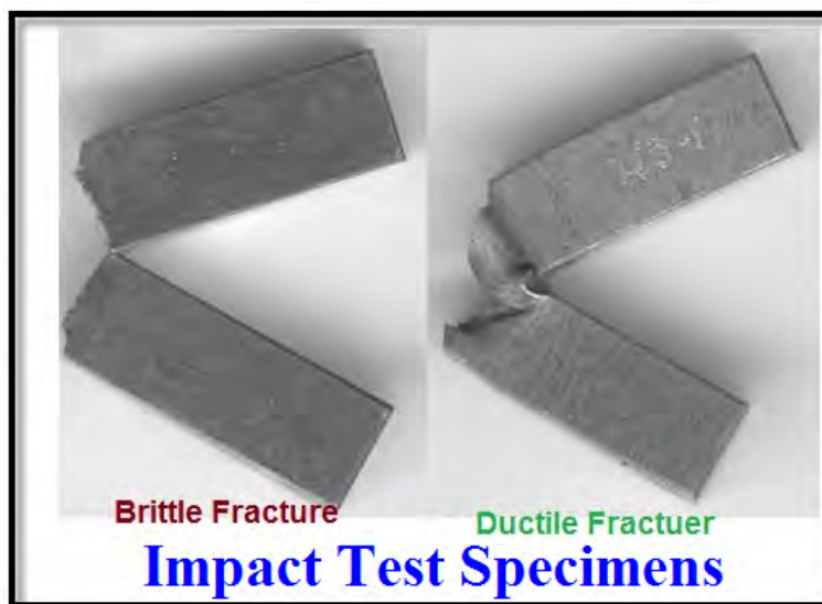
شکل ۵۳۱: مقایسه شکست ترد و شکست نرم در تست ضربه
