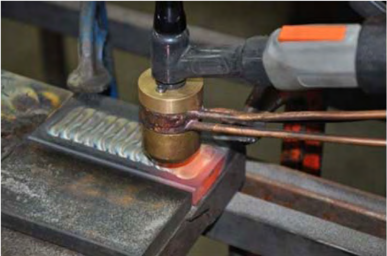
شکل-۲۸۳: نمای تورچ جوشکاری فرآیند GTAW در حال رسوب گذاری خودکار
