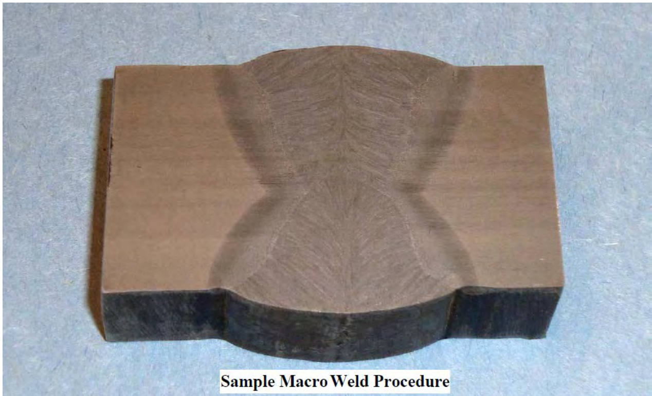
شکل-۴۶۰: نمونه‌ی قطعه آزمایش ماکرو از جوش شیاری (Groove)
