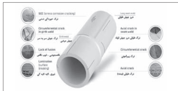
شکل ۱: تقسیم بندی نوع و موقعیت ایجاد ترک در خطوط لوله
