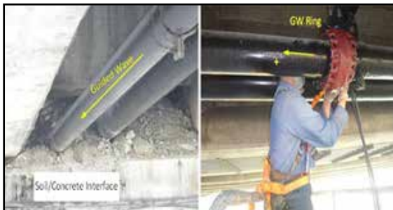
شکل ۱۰: بازرسی SIC لوله ۶ اینچی توسط GWT
