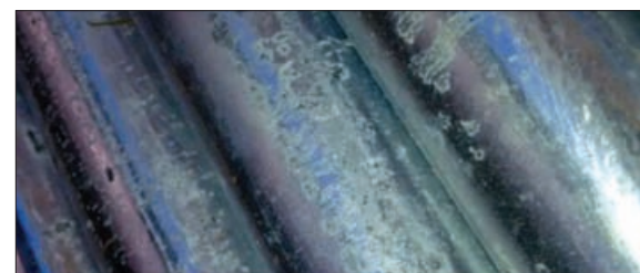
شکل ۹: یک نمونه از شوره زدگی توام با لکه های سیاه که در اثر انبارش غیر صحیح قطعات بر روی آنها ایجاد شده است
