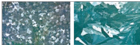
شکل ۳: ساختار پولکی (Spangle) پوشش گالوانیزه گرم
