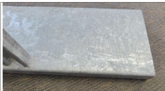
شکل ۷: نمونه‌هایی از شوره زدگی سطحی و جزئی پوشش گالوانیزه گرم قطعات صنعتی
