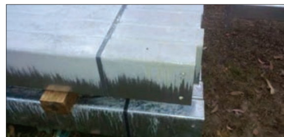
شکل ۸: یک نمونه از شوره زدگی متوسط در قطعات صنعتی که بمدت طولانی در زیر پلاستیک انبار شده اند
