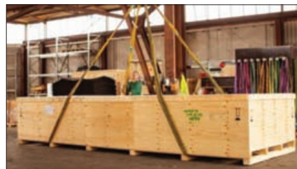
شکل ۷: نقاط و نحوه بارگیری صحیح
