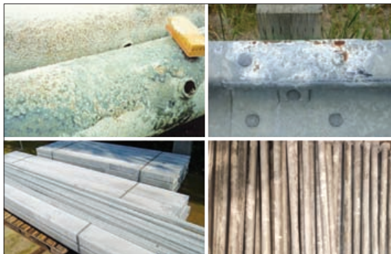
شکل ۱۰: نمونه هایی از شوره زدگی شدید قطعات گالوانیزه شده
