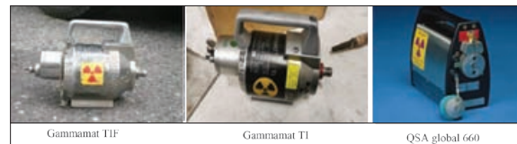
شکل ۴. چند مدل از دوربین‌هایی که اداره کل حفاظت در برابر اشعه مجوزی برای به‌کارگیری آن‌ها صادر نمی‌کند. بیش‌ترین دوربین‌ها از نوع کانال مستقیم هستند.
