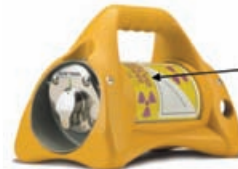
مشخصات این تأییدیه (USA/9296/B(U)-96) باید بر بدنه‌ی دوربین مشاهده شود.
