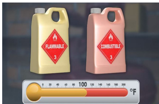
شکل ۵- کلاس بندی مایعات قابل اشتعال و قابل احتراق بر حسب نقطه اشتعال
