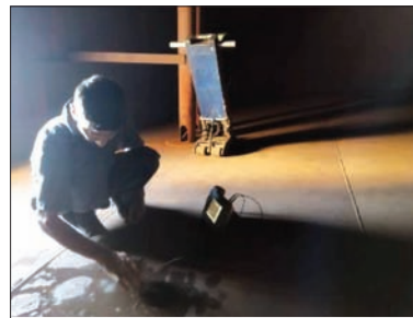
شکل ۴- اپراتور در حال اجرای روش ثانویه (تست آلتراسونیک) بر روی نقاط بحرانی آشکار شده با اسکن MFL
