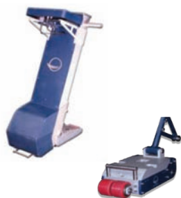
شکل ۲- دستگاه‌های اسکنر سطح MFL مخصوص کف مخازن نمونه ایرانی ۱۳۹۳
