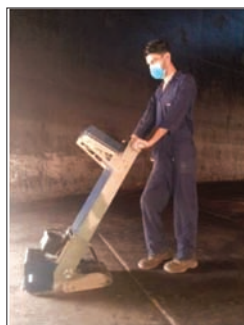
شکل ۳- اپراتور در حال تست MFL کف مخزن
